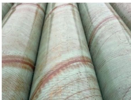
Stopień oczyszczenia S01
